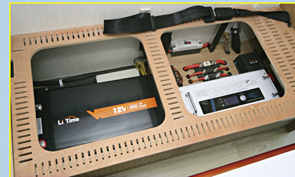
⑬ リチウムイオンバッテリー400Aとインバーター3000W 400Aというとワット数に換算すると5120Whの大容量。そのリチウムイオンバッテリーを活かすため、大出力のインバーターが必須。
