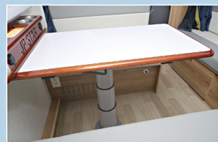
⑧ 昇降式テーブル(ベッド下地として機能) テーブルのストッパーを外すことで上下に昇降し、ベッド展開時の支えとして機能します。取り外して片付ける手間がありません。
