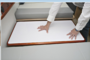
⑧ 昇降式テーブル(ベッド下地として機能) テーブルのストッパーを外すことで上下に昇降し、ベッド展開時の支えとして機能します。取り外して片付ける手間がありません。
