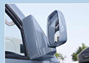
⑥ サイドミラー 張り出したキャビンの後方がよく見えるように100mm外側にオフセット
