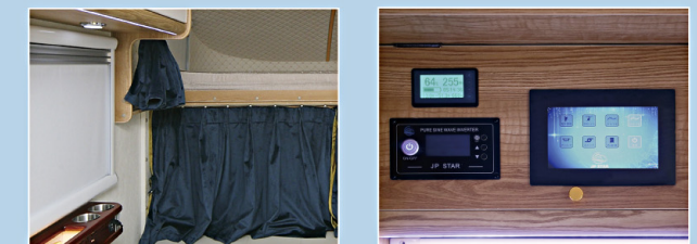
⑰ 遮光カーテン ⑱ 集中パネルスイッチ(AndroidOS) 集中パネルスイッチにはタッチパネルを使用
